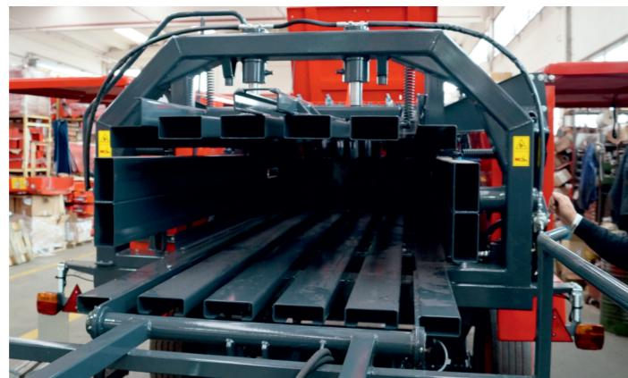
Предназначен для подбора валков сена естественных и сеяных трав или соломы, прессования их в крупногабаритные тюки прямоугольной формы с обвязкой шпагатом. По отдельному заказу пресс-подборщик может комплектоваться стаером (накопителем), который позволяет одновременно компактно выгружать сразу два расположенных друг над другом тюка. TUKAN MAX агрегатируется с тракторами класса не менее 2 т.с., в том числе возможно агрегатирование с тракторами МТЗ-1221.
